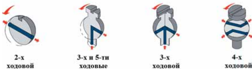
>>> Рис. 1. Принципиальные схемы многоходовых шаровых кранов сверхвысокого давления
